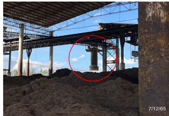
รูปที่ 14 ที่ครอบกันฝุ่นฟุ้งกระจาย
